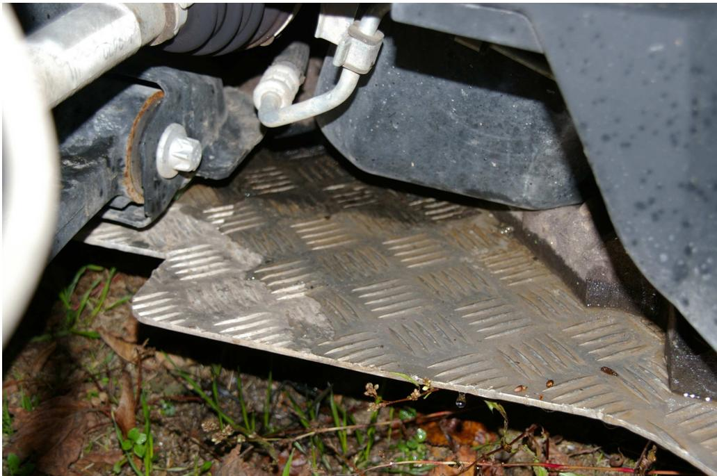
Une traverse a été fabriquée et posée en avant des 2 longerons, elle sert de support aux boulons de fixation avant.
