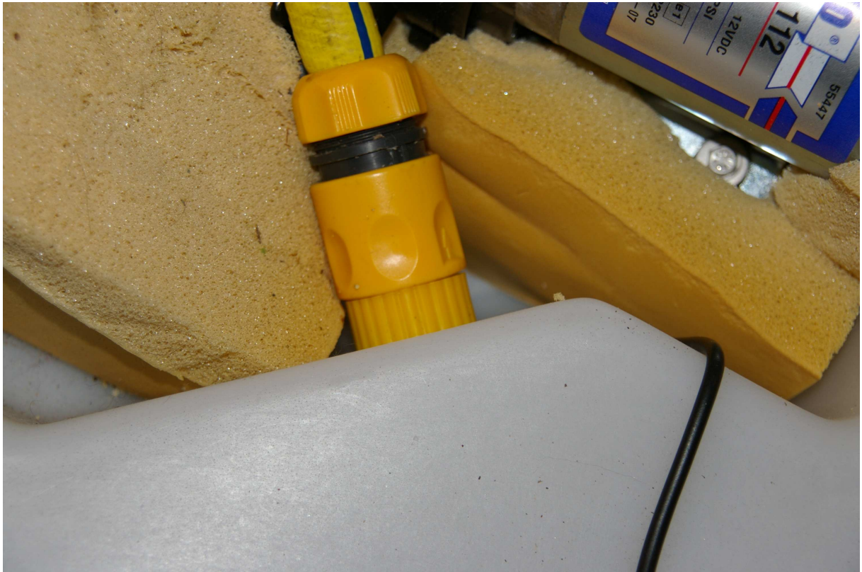
raccord d'arrivée d'eau sur le réservoir
