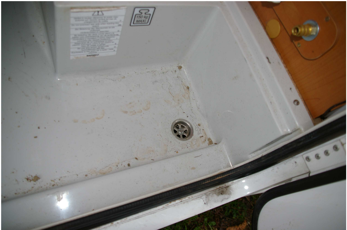
la nouvelle bonde d'évacuation en soute
