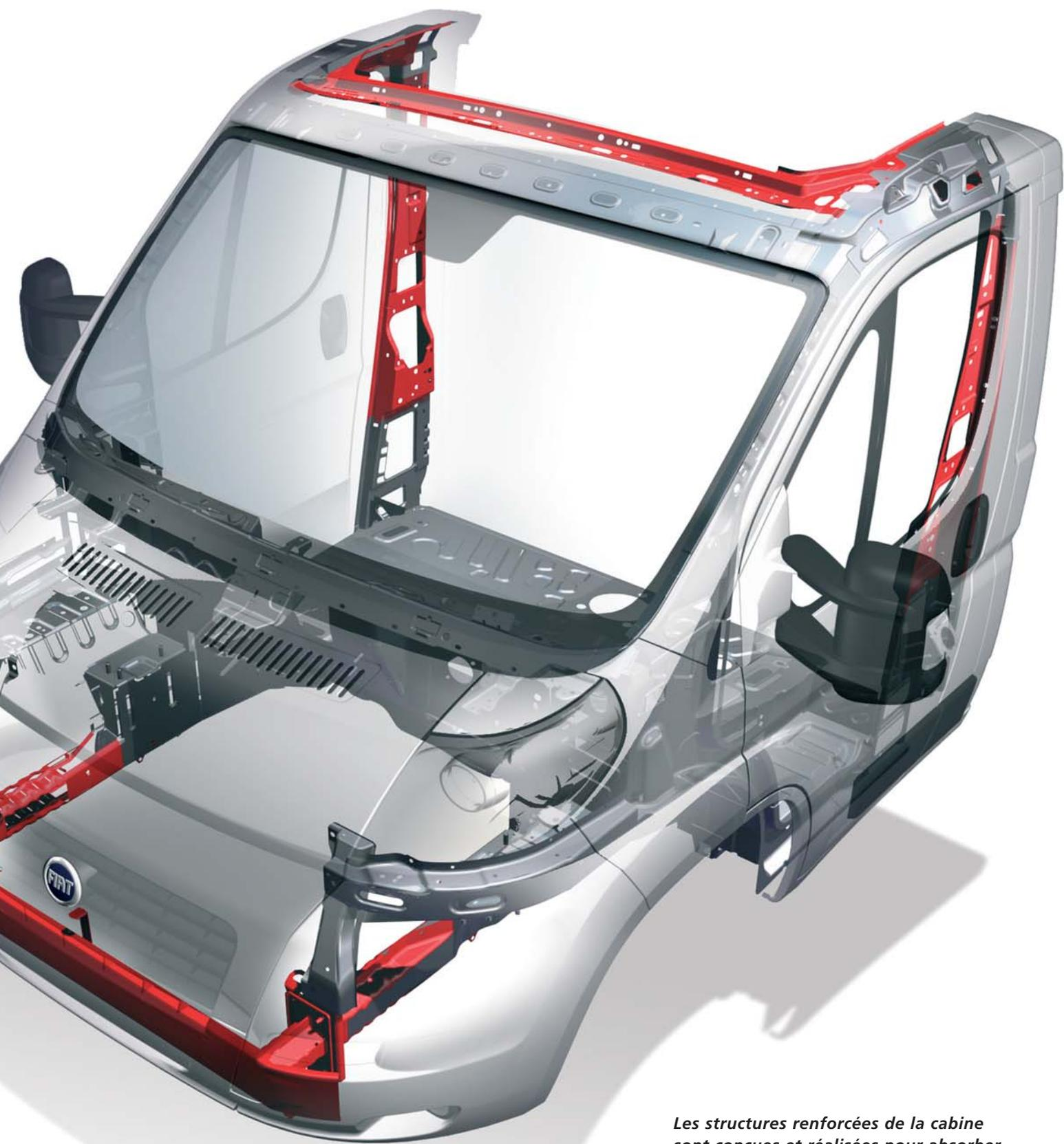
*Les structures renforcées de la cabine sont conçues et réalisées pour absorber les chocs et garantir la sécurité maximale dans l'habitacle.*
